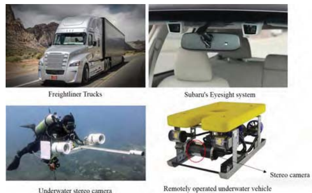
그림 1. 투명 인터페이스 내 카메라 설치의 예
